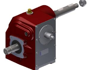
La nuova generazione moltiplicatori è dotata di una leva selettrice che permette di innestare senza difficoltà i due livelli di velocità. L'impiego di cuscinetti a rulli di alta qualità permette, a differenza dei cuscinetti a sfera tradizionali, di ottenere minori attriti e una maggiore durata dell'ingranaggio.
